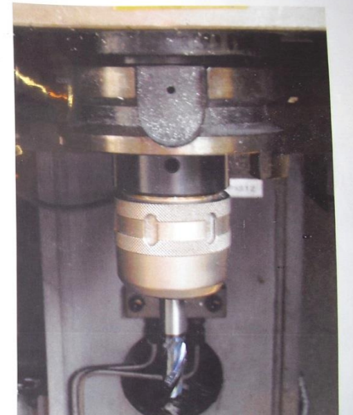
注) 溶着または欠損が無い確認する事!
